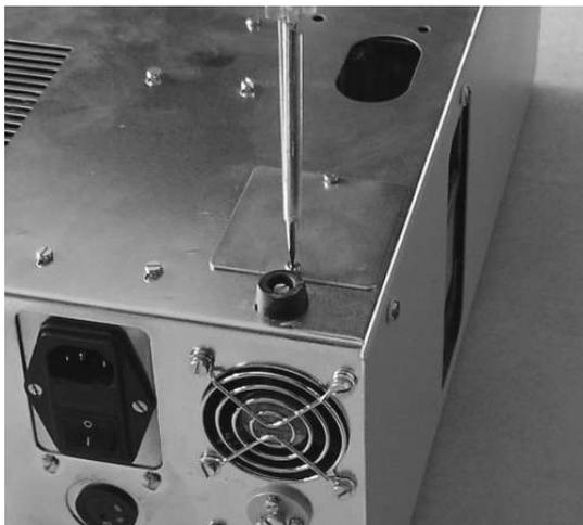
Рис. 1. Отворачивание крепежных винтов крышки лампового отсека
