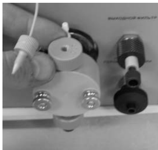
Фото 2 Ослабление корпуса выходного клапана
