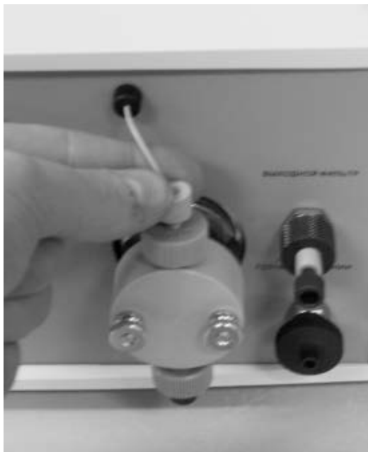
Фото 1 Отворачивание капилляра от выходного клапана
