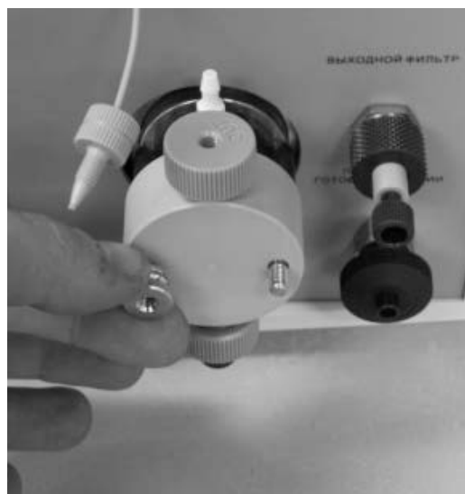
Фото 3 Отворачивание барашков головки насоса
