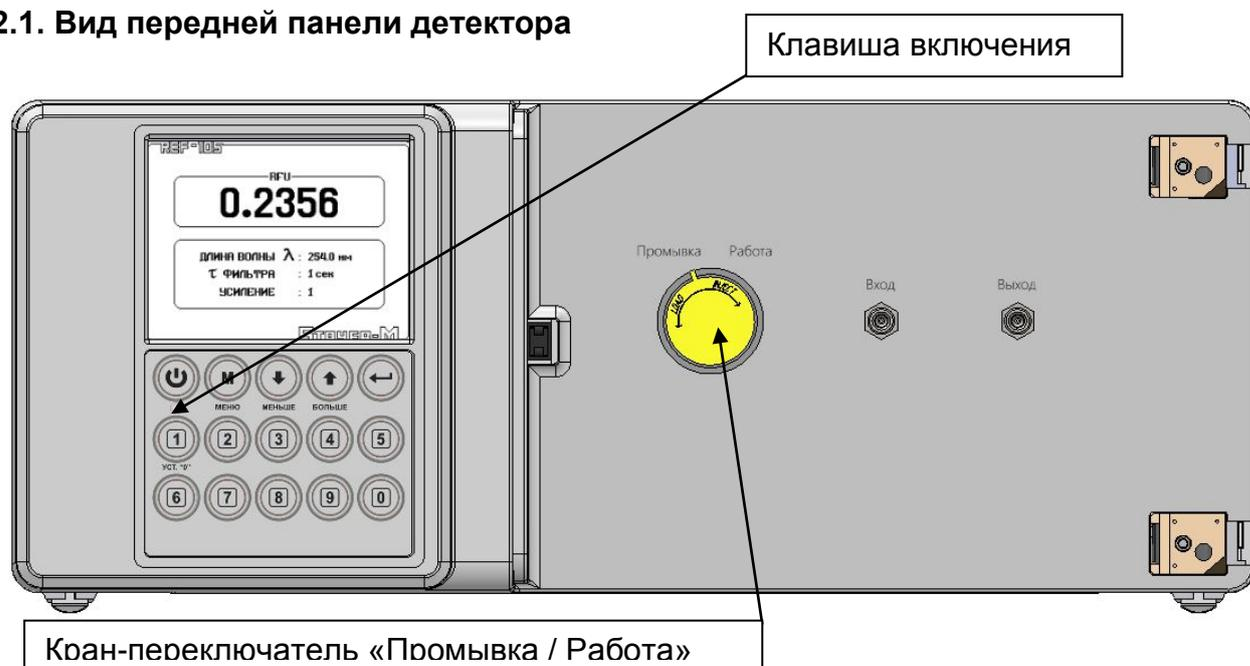
1. В крайнем левом положении («Промывка/LOAD») осуществляется промывка рабочей и сравнительной ячеек.
