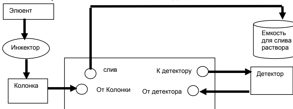
Рис.6 Подключение гидравлических линий в режиме автоматического подавления фоновой электропроводности элюента.
