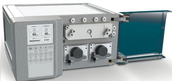
Ионная хроматография традиционно приоритетна для нашей компании. Стараясь всячески развивать это направление, мы создали очень удобный блок в системе «Стайер-М», конструктивно и с точки зрения управления, сочетающий в себе генератор и подавитель фоновой электропроводности элюента. Таким образом, пользователь получает единый блок, полностью берущий на себя все проблемы получения элюента нужного состава.
